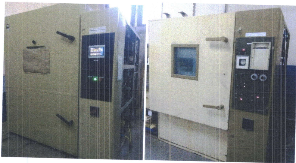
Рисунок 3 – Кліматичні камери для відтворення циклічних кліматичних впливів
