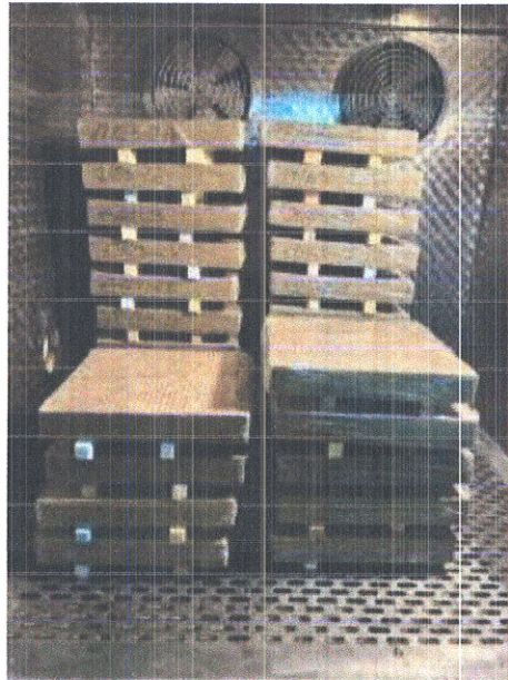
Рисунок 4 – Дослідні зразки, які піддають циклічному температурному впливу
