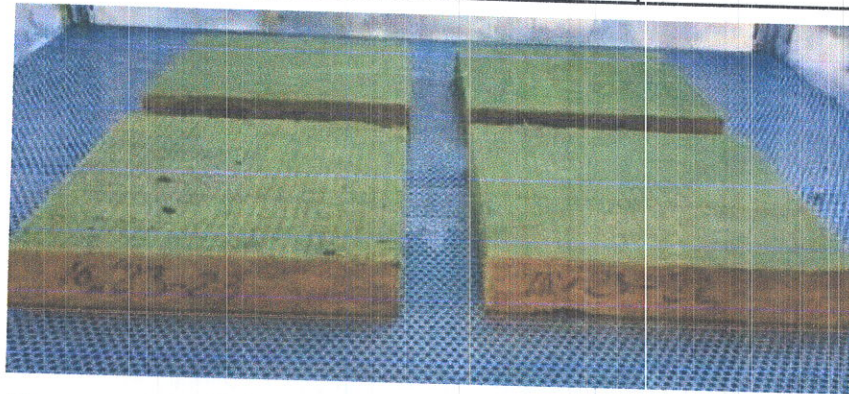
Рисунок 8 – Загальний вигляд дослідних зразків № 16/23 теплоізоляційного матеріалу марки «THERMOWOOL ROOF V EXTRA 170» під час опромінення
