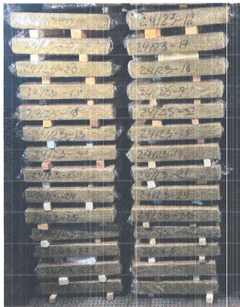
Рисунок 4 – Дослідні зразки, які піддають циклічному температурному впливу
