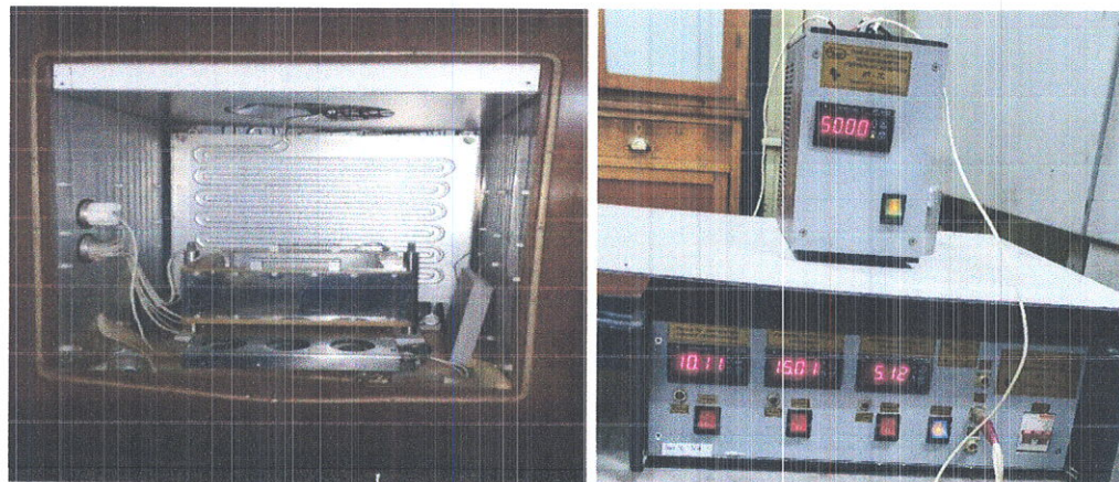
Рисунок 2 – Установка для визначення теплопровідності згідно з ДСТУ Б В.2.7-105-2000
